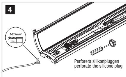
**4** Anslut nätkabeln, skala kabeln med 10 mm för att exponera kabelns kärna.
