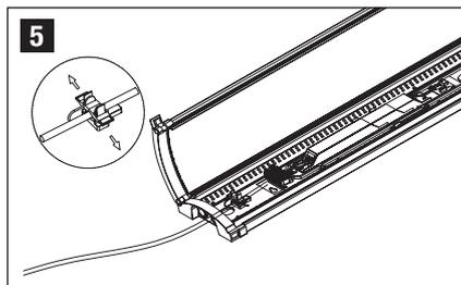
**5** Trä strömkabeln genom silikonpluggen, koppla in och fäst den i den 5-poliga plinten.
