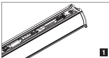
**1** Öppna magnetspännet på båda sidor, tryck på magneten spänn fast och vrid 110° för att öppna kupan.
