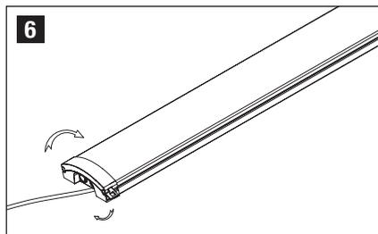
**6** Fäst kupan på lamphuset och lås magnetspännet, slutför kabeldragningen.
