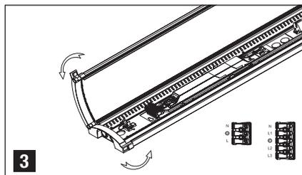
**3** Tryck på magnetspännet i båda ändar och rotera 110° för att öppna kupan.
